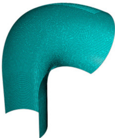
Hình 3. Mô hình chia lưới phôi ống
