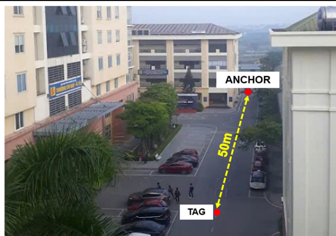
Hình 17. Thử nghiệm đo thay đổi kích thước gói tin ở khoảng cách 50m
