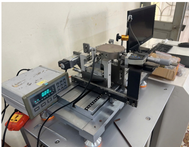
Hình 4. Bố trí thí nghiệm thực tế của đồ gá xác định độ cứng đàn hồi của gối đỡ
