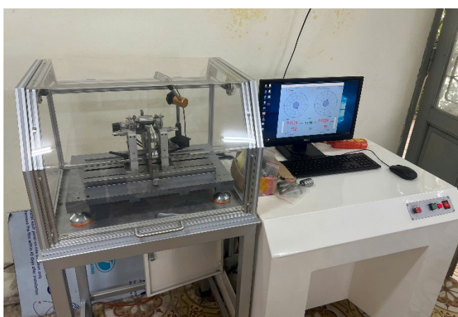
Hình 7. Hình ảnh thực tế của thiết bị cân bằng động rô to sau khi chế tạo
