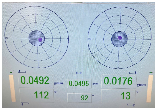
Hình 6. Màn hình hiển thị của thiết bị cân bằng động rô to trên máy tính
