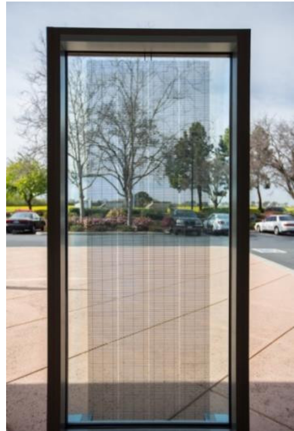
Hình 2. Tấm kính quang điện CdTe bán trong suốt sử dụng trong nghiên cứu
