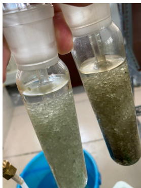
Hình 6. Bình lọc syngas khí có và không có xúc tác
