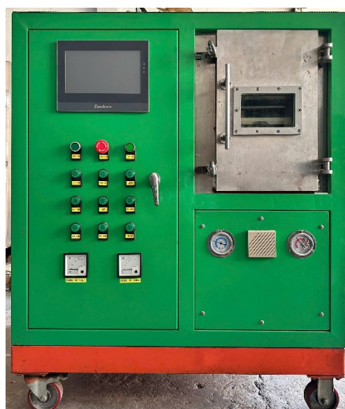
Hình 1. Sơ đồ nguyên lý và hình ảnh máy sấy chân không
