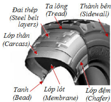
Hình 1. Cấu tạo lốp Radial
