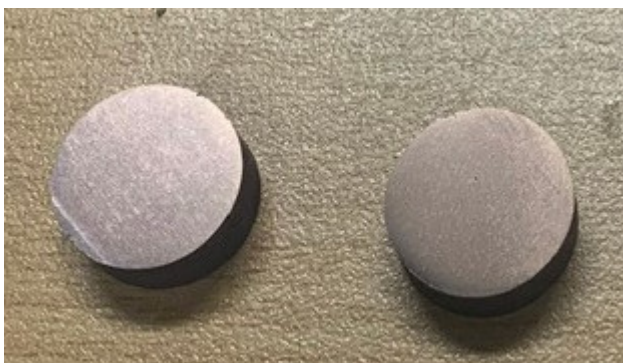
Hình 4. Hình ảnh mẫu SKD61 đã được phủ TiAlN
