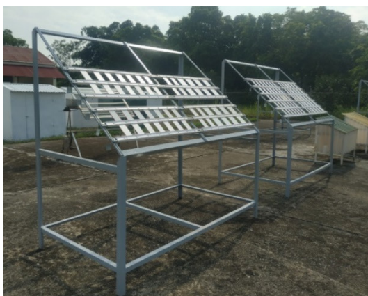
Hình 4. Thử nghiệm tính chất trang trí bảo vệ của các loại sơn trên sân phơi ngoài trời
