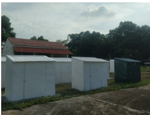
Hình 3. Thử nghiệm chống nóng các loại sơn trên sân phơi ngoài trời
