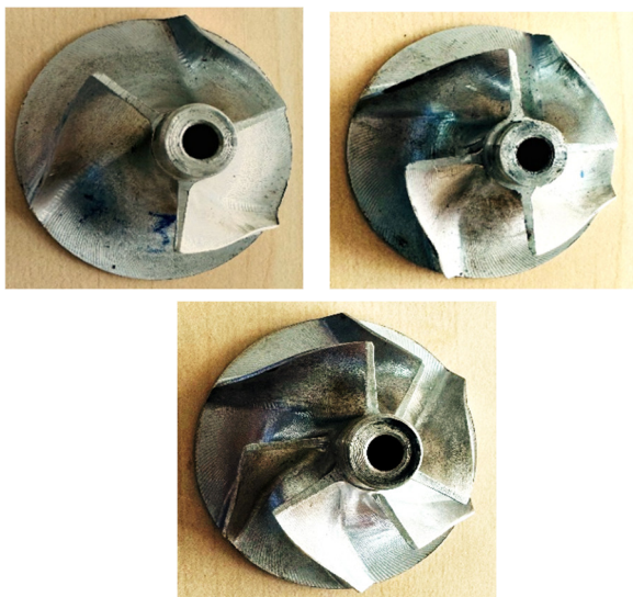
Hình 3. Các bánh nén được gia công từ máy CNC
