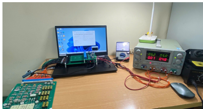
Hình 8. Kiểm tra khối 6P223 tại phòng thí nghiệm bằng hệ thống kiểm tra KT-OKA
