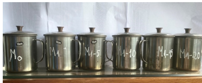
Hình 2. Các mẫu bitum được biến tính bằng nanoclay I28E và dầu thải
