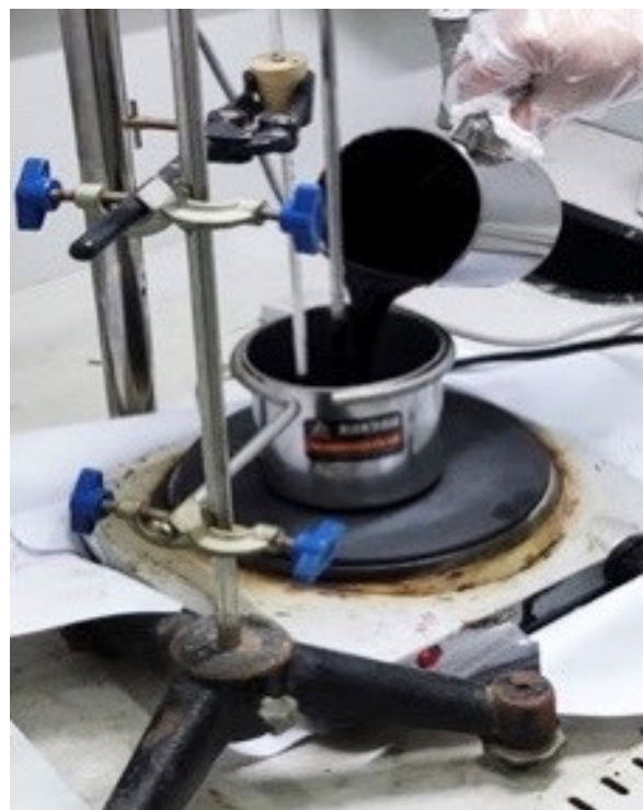
Hình 1. Phân tán nanoclay I28E và dầu thải vào bitum
