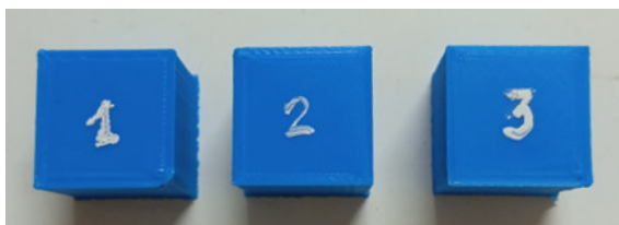
Hình 18. Hình ảnh mẫu in kiểm nghiệm trên máy in 3D được chế tạo
