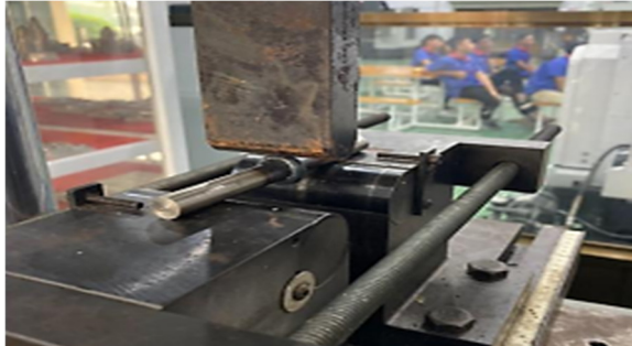
a) Gá mẫu thử lên máy thử uốn
