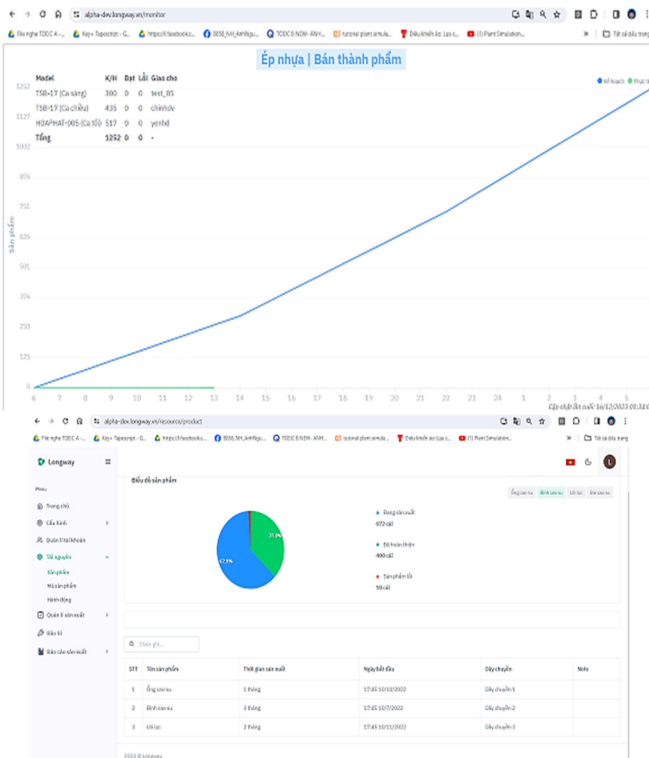
Hình 16. Giao diện phân tích hiệu suất của công nhân được tích hợp trong hệ thống MES và biểu đồ tình hình sản xuất của nhà máy
