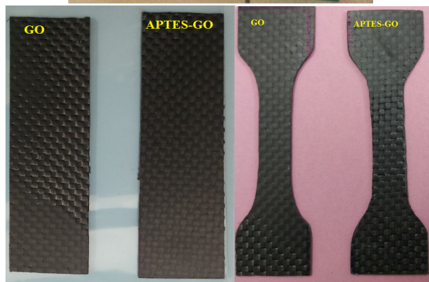
Hình 5. Một số hình ảnh chế tạo mẫu nanocompozit vải sợi cacbon/epoxy
