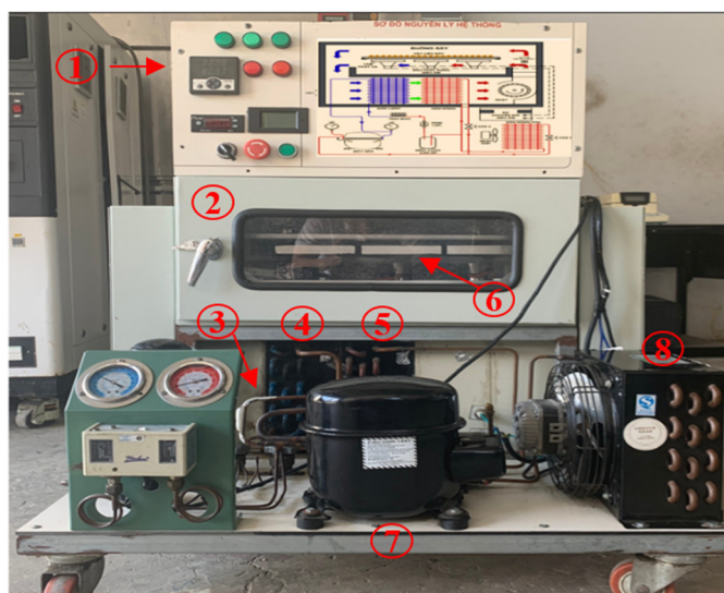
Hình 1. Hệ thống sấy bơm nhiệt kết hợp sóng siêu âm
