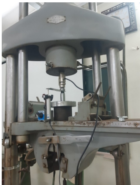
Hình 3. Sơ đồ thí nghiệm trên máy thử kéo
