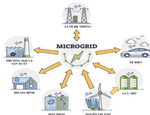
Hình 1. Cấu trúc Microgrid
