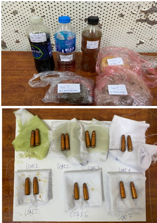
Hình 8. Các loại chất bôi trơn và mẫu đã bôi chất bôi trơn khi tiến hành thực nghiệm
