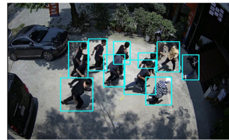
(b) Kết quả với YOLO V3 tiny
