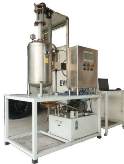
Hình 5. Hệ thống tạo áp suất đột biến để kiểm tra rò rỉ áp lực chế tạo
