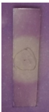
Hình 4. Hoạt tính chống oxi hóa của axit hydroxycinnamic (axit ferulic và p-coumaric) từ mùn gỗ sau 20 phút ủ trên hệ agar-DPPH
