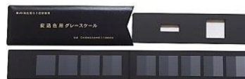
Hình 2. Thang màu xám đánh giá sự thay đổi màu theo tiêu chuẩn JIS L 0804
