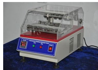
Hình 4. Thiết bị kiểm tra độ bền ma sát HUST TONY INSTRUMENTS
