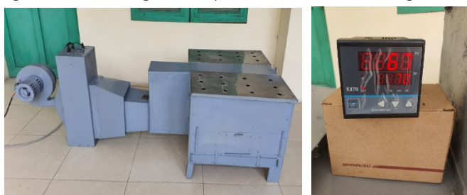
Hình 3. Hình ảnh “mẫu” máy sấy hiệu suất cao tiết kiệm năng lượng sau khi chế tạo dùng cho nghiên cứu thực nghiệm
