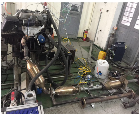
Hình 1. Động cơ D4BB lắp bộ DOC-DPF-SCR trên băng thử
