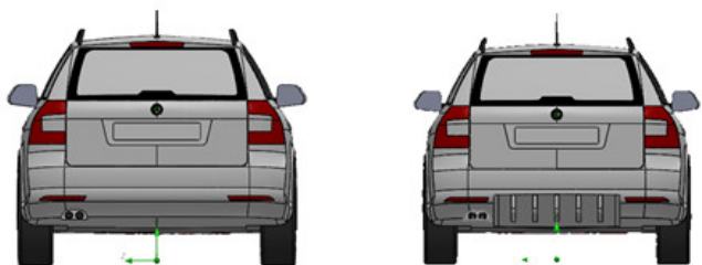
Hình 2. Mô hình xe SUV trước và sau khi lắp thiết bị khuếch tán gió cản sau
