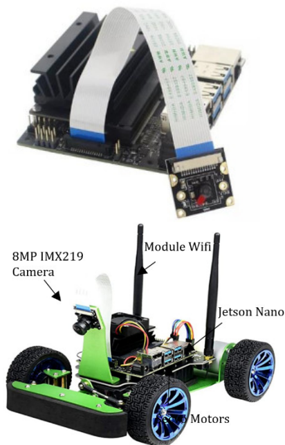
Hình 3. Mô hình rô bốt tự hành với máy tính nhúng Jetson nano và camera 8MP IMX219
