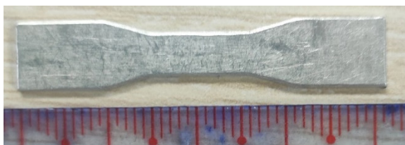
Hình 10. Chi tiết thí nghiệm bằng hợp kim nhôm AA2024-0
