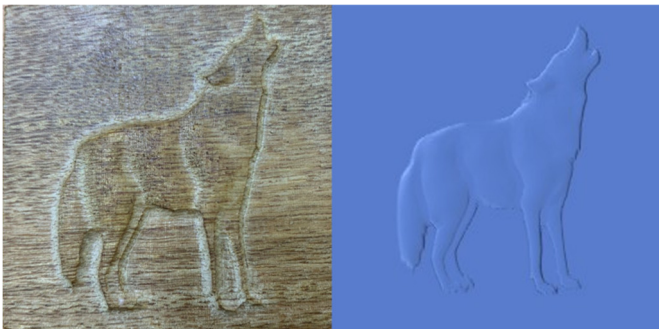
Hình 7. So sánh kết quả gia công trên máy thực với bản sao số
