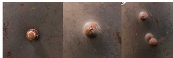
Hình 7. Kết quả bắn thực nghiệm mục tiêu dày 6mm cự ly 25m
