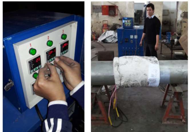
Hình 7. Thực hiện gia nhiệt mới hàn theo quy trình xử lý nhiệt
