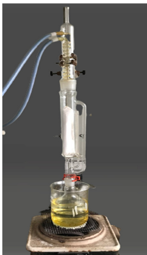
Hình 1. Hệ thống chiết Soxhlet dịch chiết tỏi
