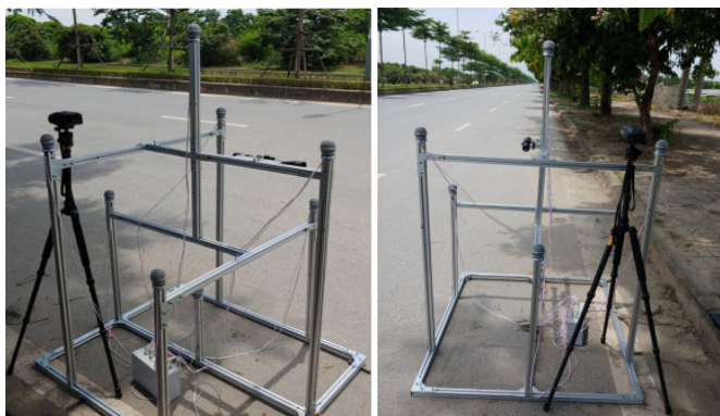
Hình 7. Cụm cảm biến thu tín hiệu âm thanh
