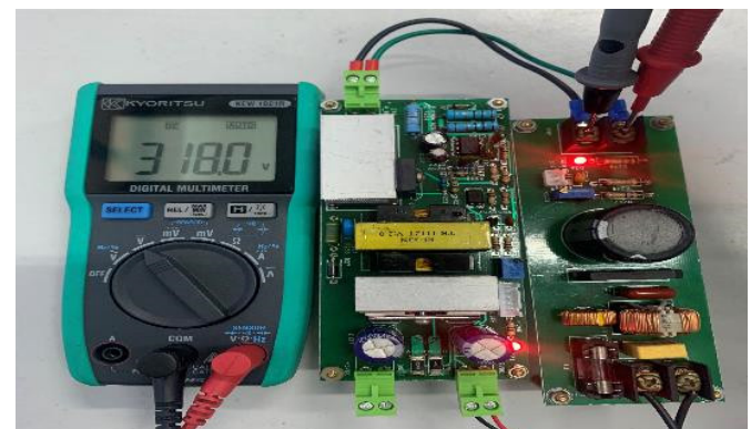
Hình 12. Kết quả đo điện áp ngõ ra bộ chỉnh lưu 318VDC
