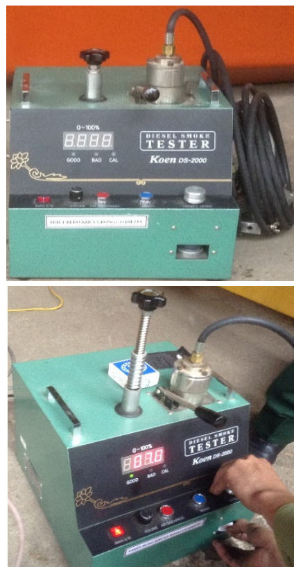
Hình 4. Thiết bị và hiển thị kết quả đo nồng độ khói đen
