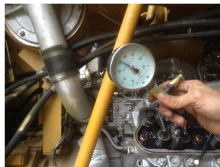
Hình 2. Thiết bị và kết quả đo áp suất cuối nén
