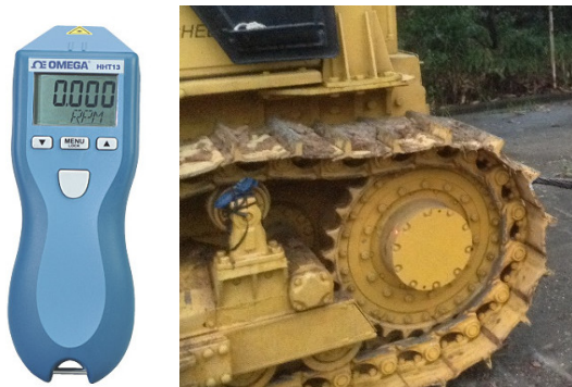
Hình 5. Đồng hồ đo số vòng quay và lắp đặt lên máy ủi
