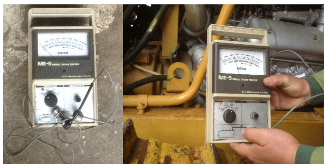
Hình 3. Thiết bị và kết quả đo tốc độ quay trục khuỷu động cơ
