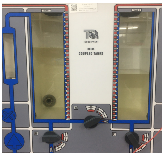
Hình 12. Mức chất lỏng thực tế ứng với giá trị đặt 112,5 mm (độ mở van A và C tại 60%)
