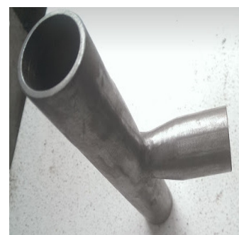
Hình 3. Thiết bị làm mát venturi đã được thiết kế chế tạo
