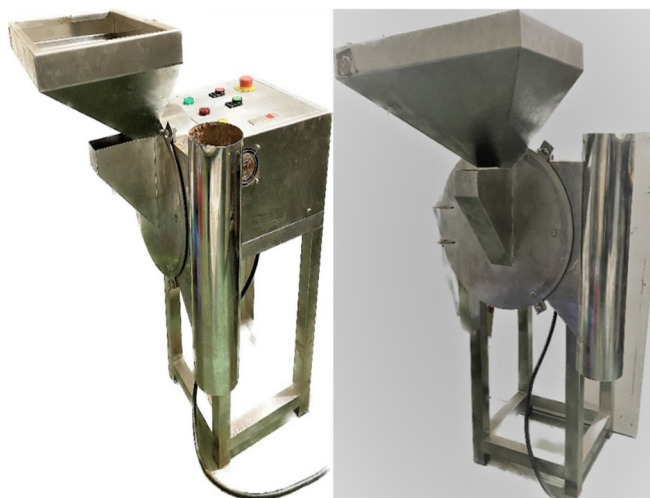
Hình 9. Máy đập vỡ bánh cacao đã chế tạo
