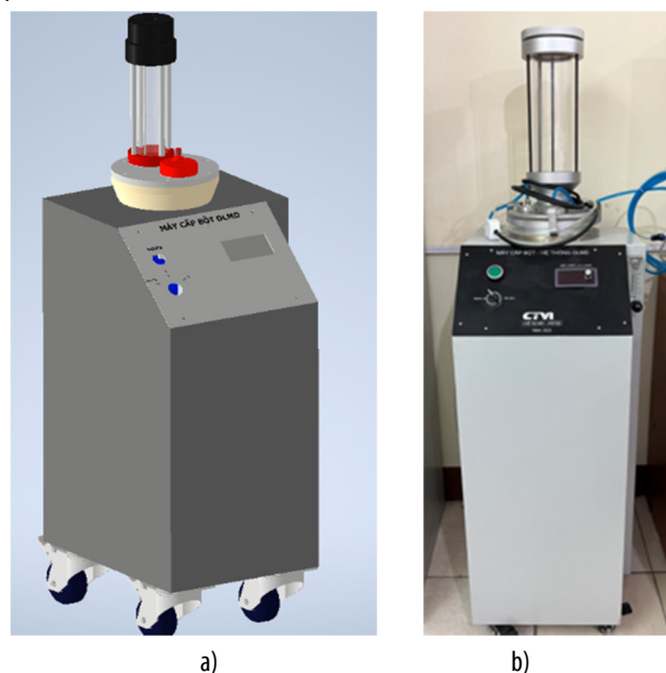
Hình 3. Hệ thống cấp bột dạng đĩa quay: (a) Mô hình thiết kế; (b) Hệ thống cấp bột chế tạo
