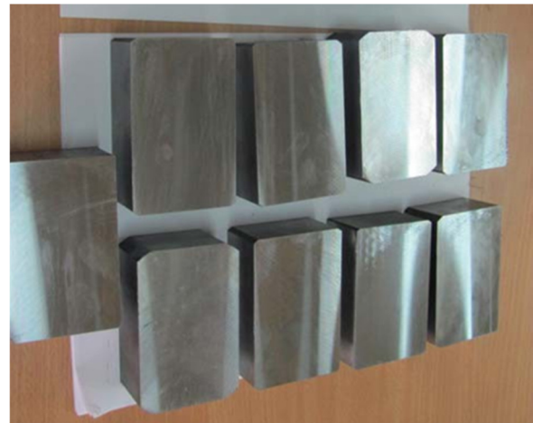
Hình 6. Thép C45 dùng trong thí nghiệm
