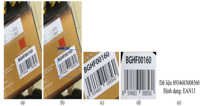
Hình 6. Kết quả minh họa quá trình phát hiện và giải mã mã vạch
