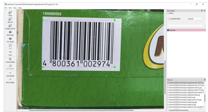
Hình 5. Gán nhãn mã vạch bằng công cụ Labellmg
