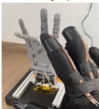
Hình 13. Kiểm tra hoạt động của các ngón tay có độ cong nhỏ
