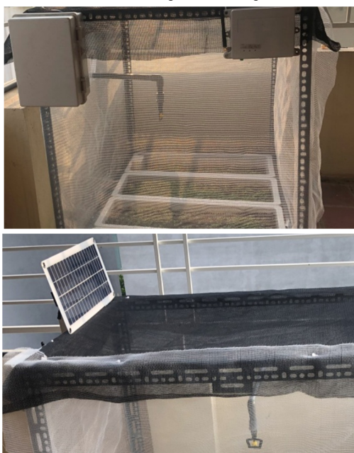
Hình 17. Vị trí lắp đặt các thiết bị điều khiển, pin mặt trời
