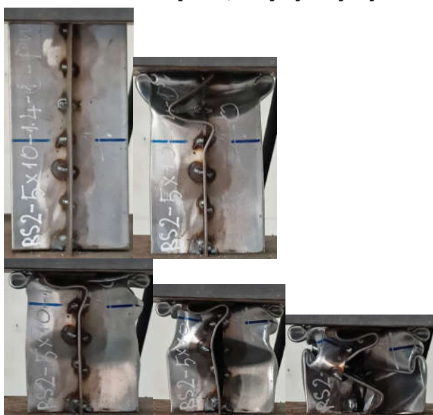
Hình 4. Quá trình nén của ống chữ nhật với 2 gân tăng cứng
