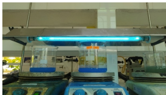
Hình 1. Thiết bị thí nghiệm phản ứng quang trên ZnO-CeO 2
