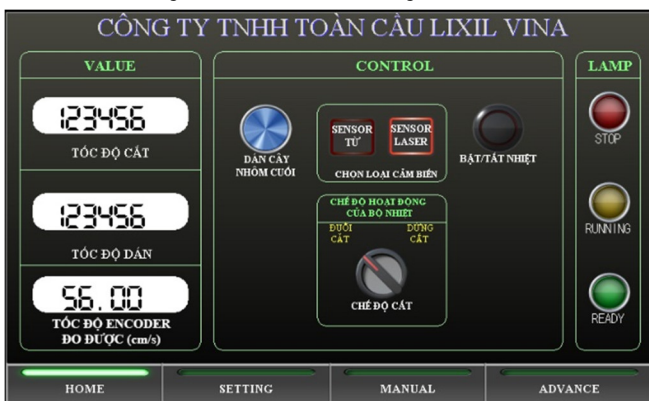
Hình 12. Giao diện điều khiển HMI
