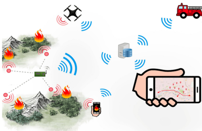
Hình 5. Sơ đồ phát hiện cháy rừng thông qua cảm biến và blockchain
