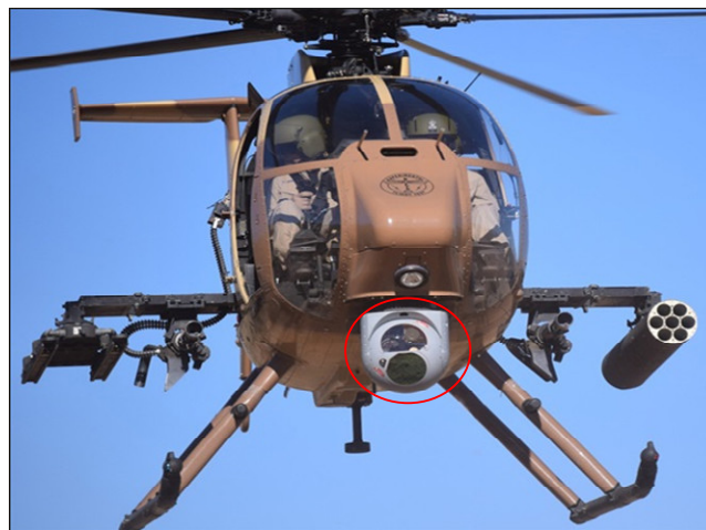
Hình 1. Hệ kính ngắm quang học trên máy bay trực thăng
