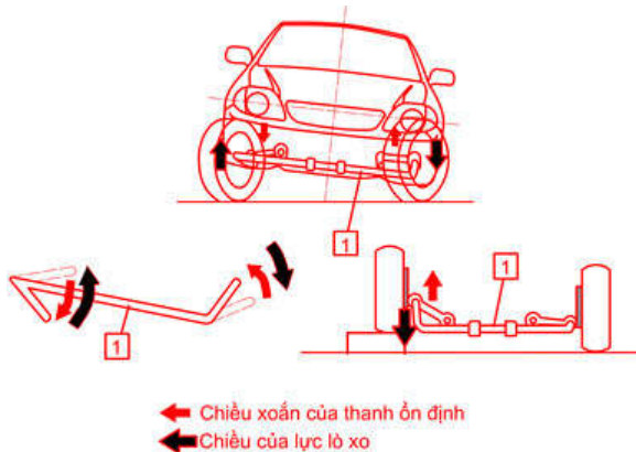
Hình 2. Nguyên lý làm việc của thanh ổn định ngang bị động
